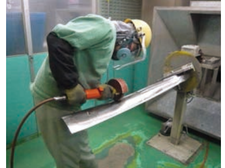
ブレード仕上げ作業(長翼)
