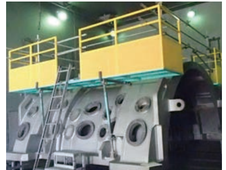
自家で製作したプラスト作業高所作業用足場
