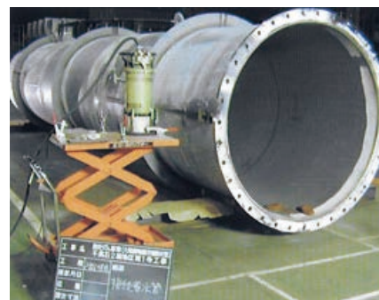
溶接部X線検査
