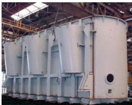
変圧器タンク製作
