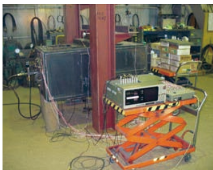
圧力容器の応力測定
